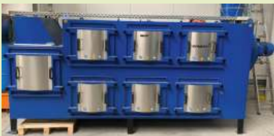
Obr. 4 Filtrační jednotka se 6 třicetkilovými patronami na aktivní uhlí, které maximálně absorbují těkavé organické látky z impregnačních autoklávů.
