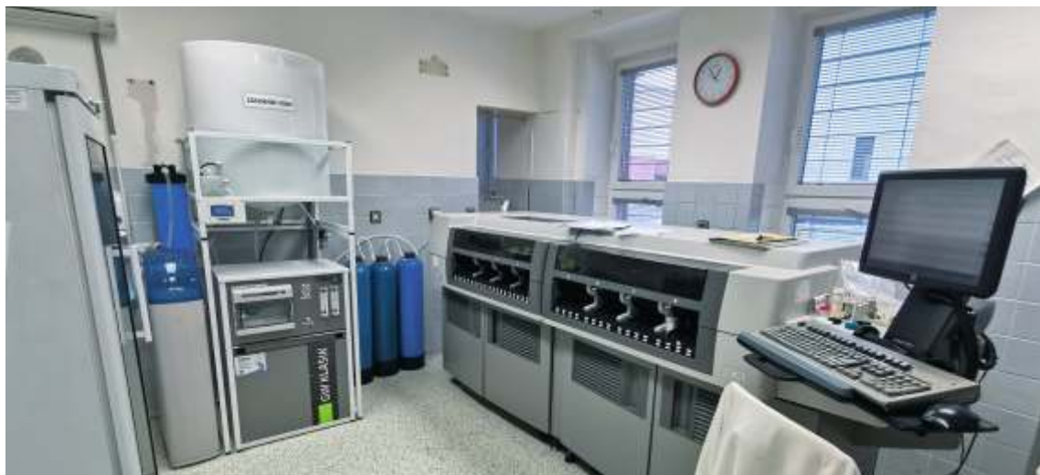
Reverzní osmóza GW KLASIK v biochemické laboratoři. Autorka fotografie: Šárka Burýšková
