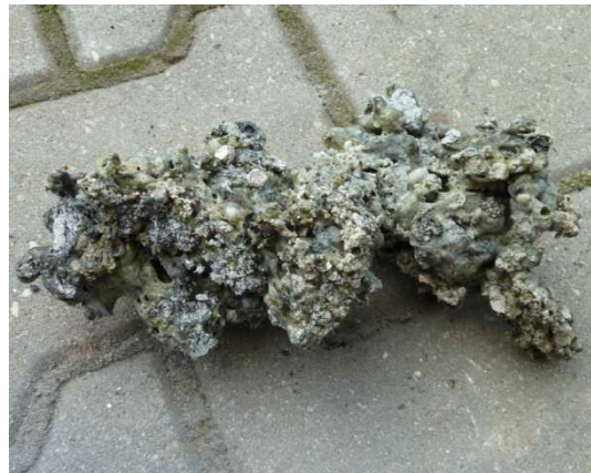
Obr.2 Pelety z pšeničné slámy a struska vzniklá při po zplyňování
